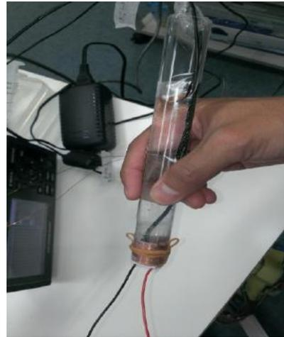
Fig. 2 作製した手持型凍結加温手術装置
